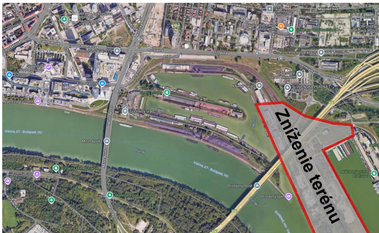
Obr. 11.2 – Územie v ktorom je pre zlepšenie odtokových podmienok potrebné preveriť možnosť zníženia terénu.
