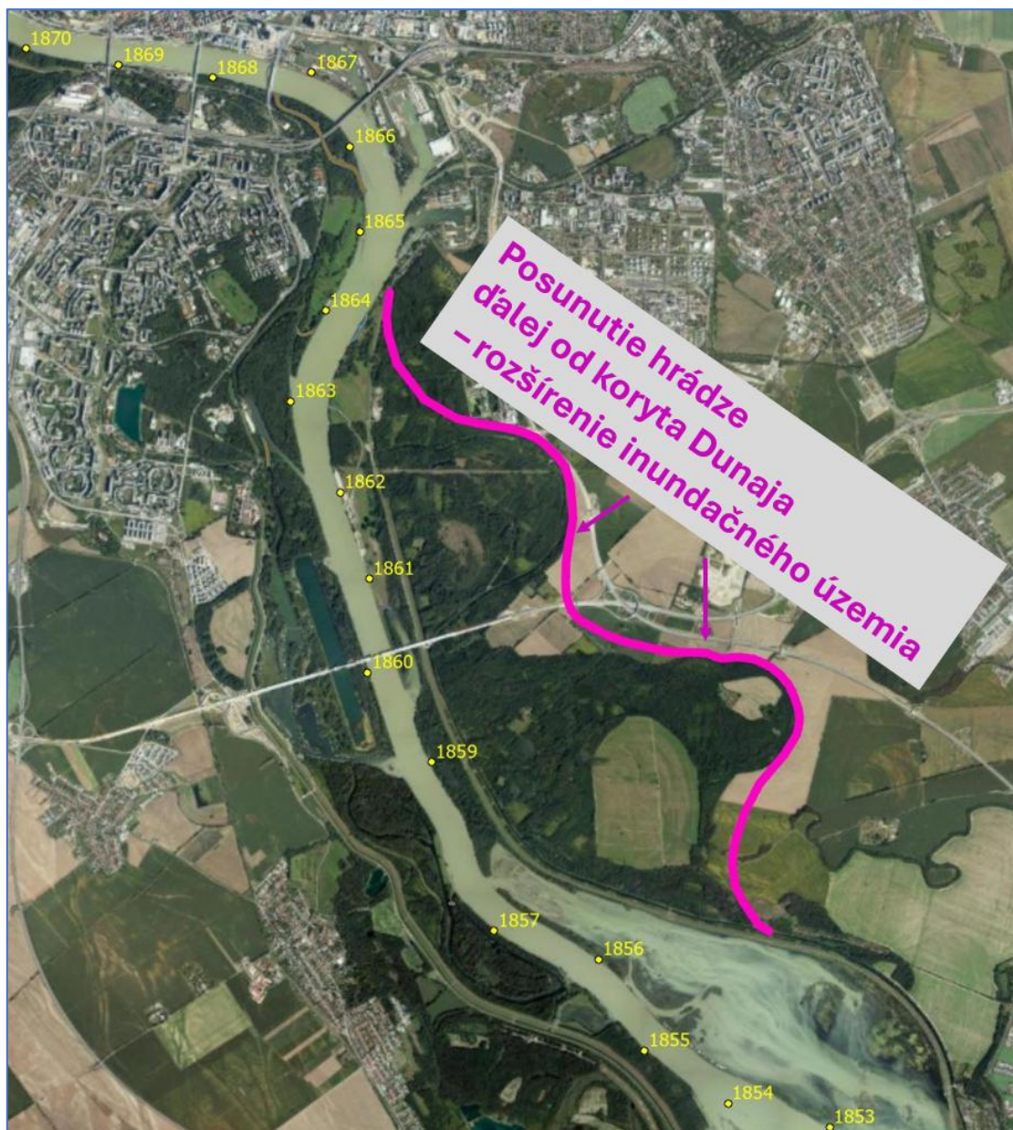
Obr. 8.3 Posunutie ľavostrannej hrádze Dunaja za ostrov Kopáč a Gajc – príklad kompenzačného opatrenia zmenšenia inundačného objemu vody v priestore Zimný prístav – Pálenisko, ako súčasť komplexného riešenia protipovodňovej ochrany Bratislavy.
