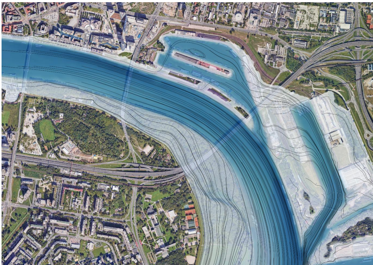
Obr. 6.4 - Grafické znázornenie smeru prúdenia 100-ročnej vody pri variante V3
