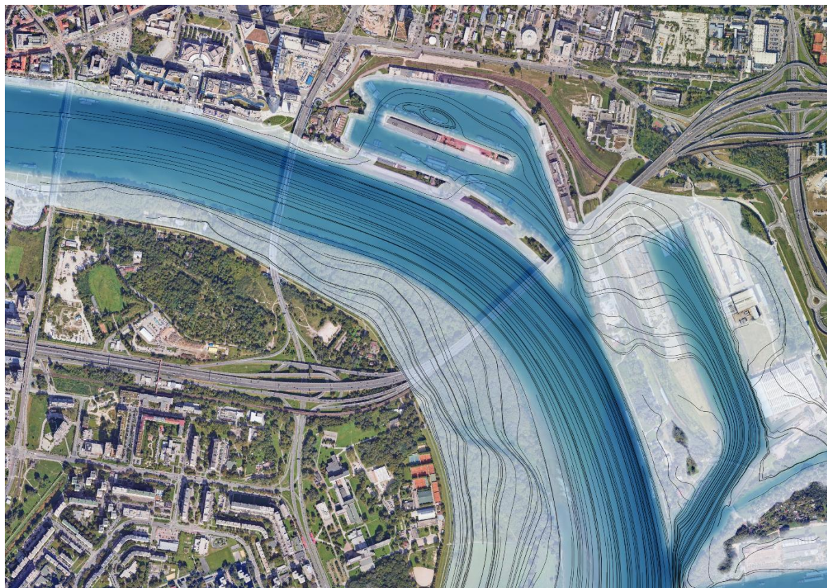
Obr. 4.4 - Grafické znázornenie smeru prúdenia 100-ročnej vody pri variante V1-max
