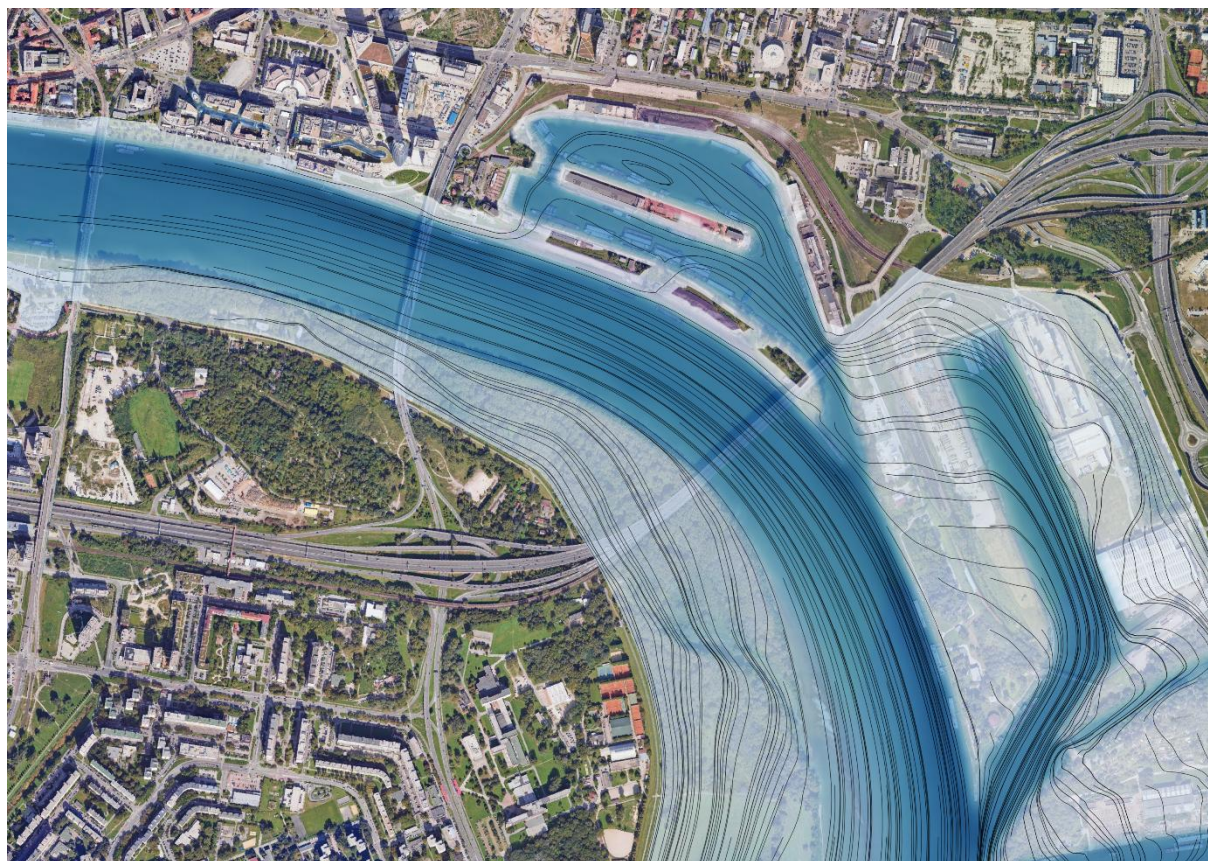
Obr. 4.5 - Grafické znázornenie smeru prúdenia 1000-ročnej vody pri variante V1-max
