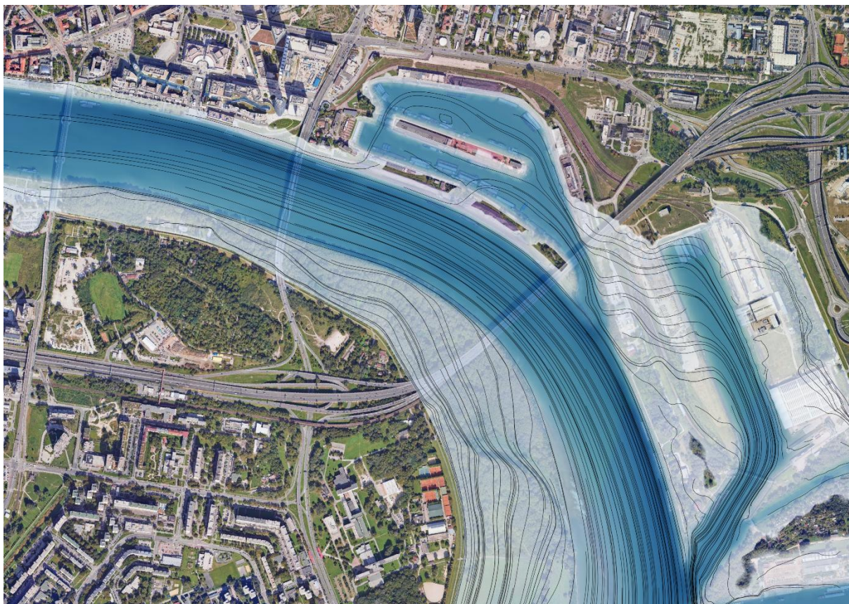
Obr. 5.4 - Grafické znázornenie smeru prúdenia 100-ročnej pri variante V2
