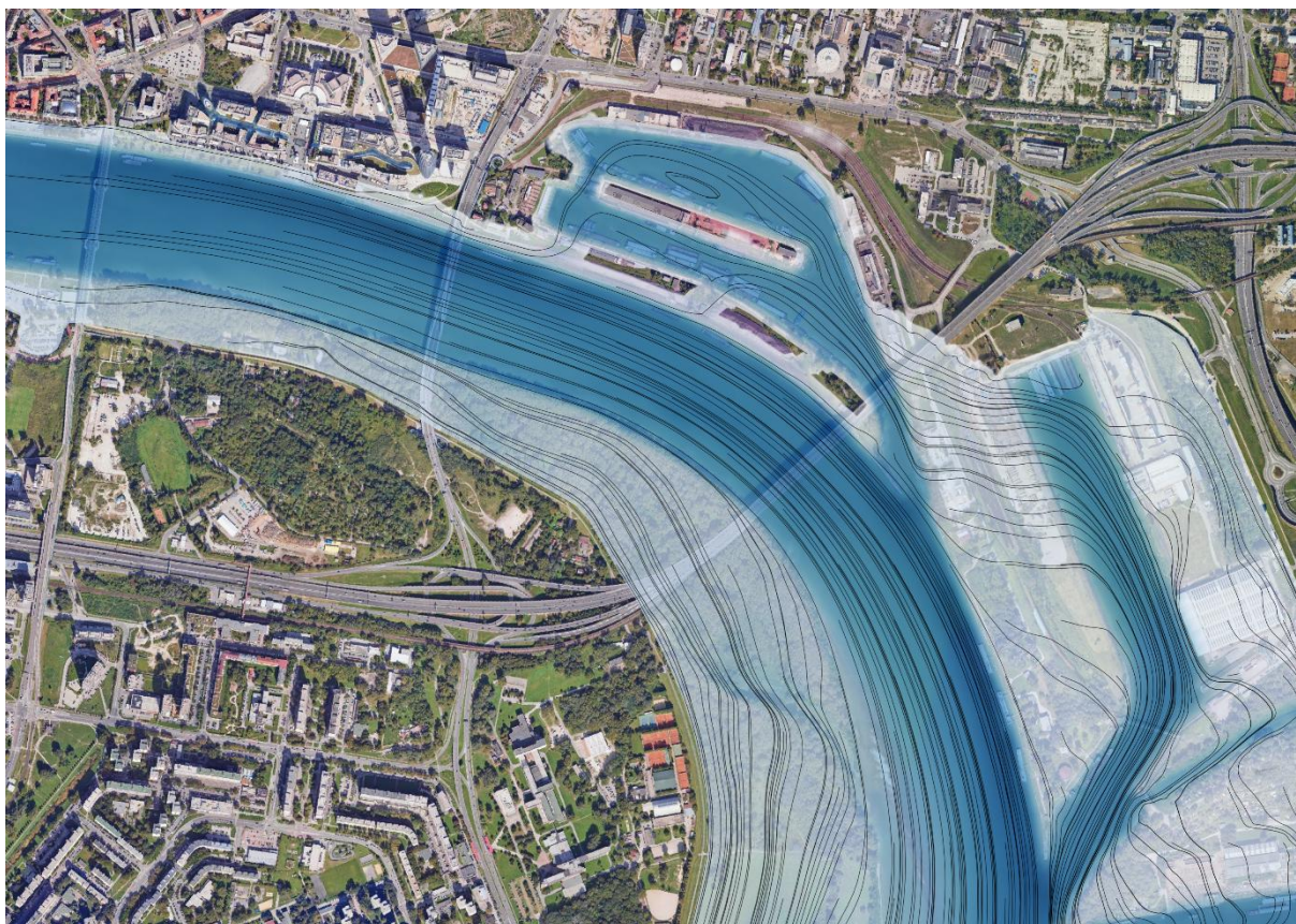
Obr. 5.5 - Grafické znázornenie smeru prúdenia 1000-ročnej vody pri variante V2
