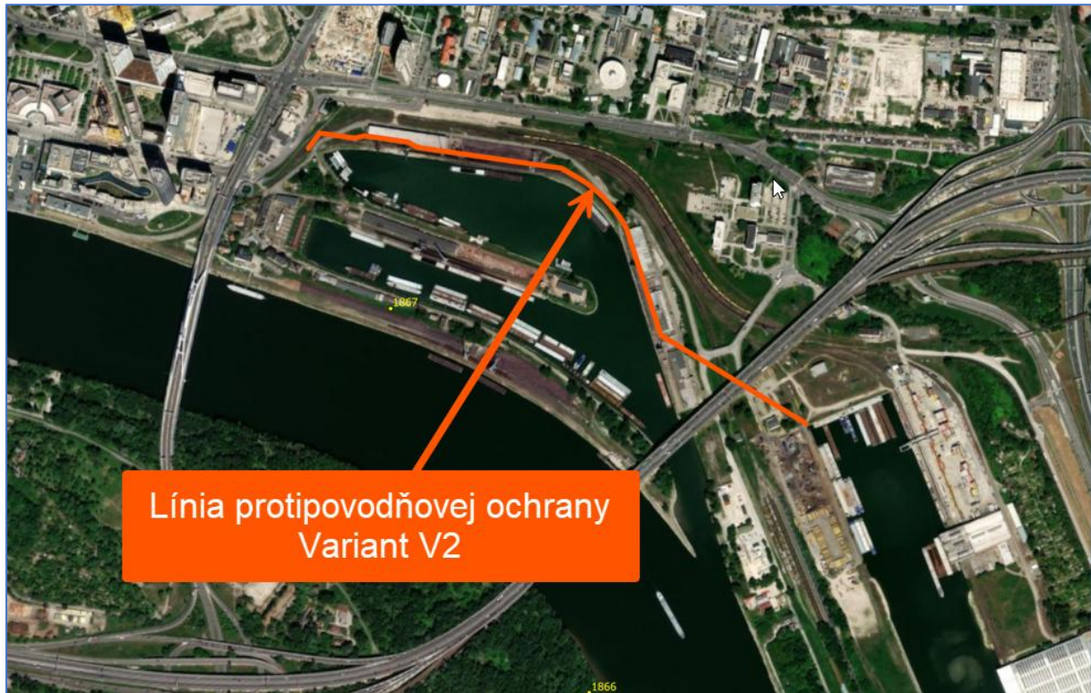
Obr. 5.1 – Línia protipovodňovej ochrany podľa variantu V2
