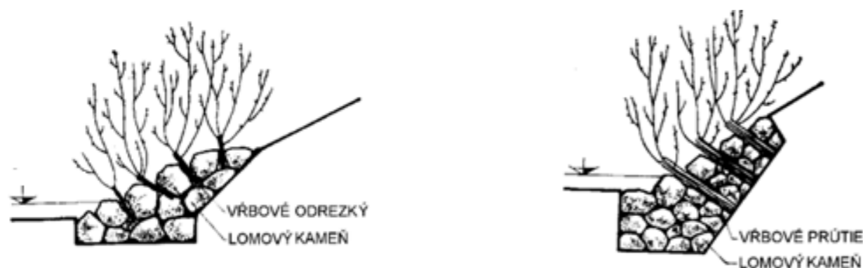
Obrázok 34: Príklad vegetačného spevnenia svahov oživenou nahádzkou a oživenou rovnatinou
